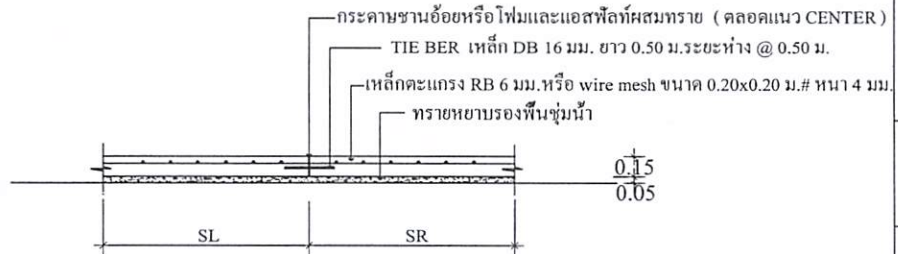
ขยาย ③ LONGITUDINAL JOINT
